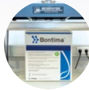
Kompressions- und Stapelprüfung (BCT) ISO 12048
